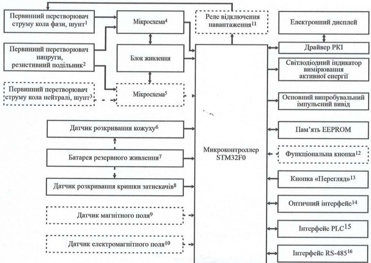
Рисунок 1. Структурна схема лічильників NIK 2100 A...P2...
